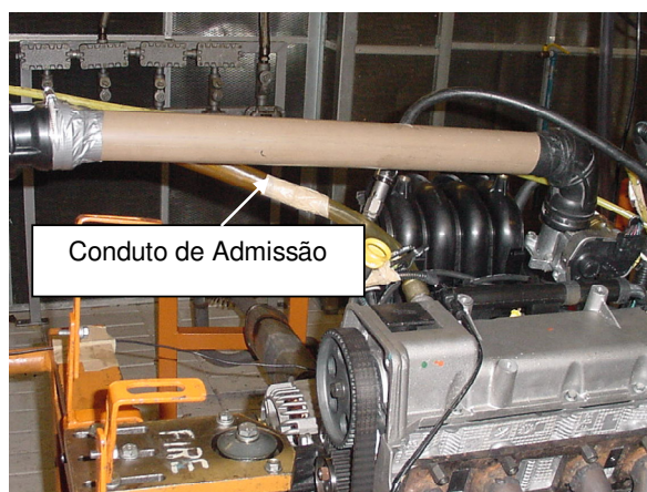
Figura 1 - Conduto de admissão de ar do motor
