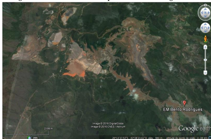
IMAGEM 3: Imagem aérea da barragem da Samarco depois do rompimento. Fonte: Google Earth. Acesso em: 06/ junho/2016.
